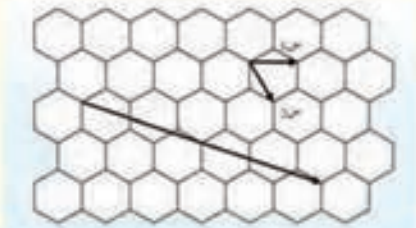
● شكل (٥) الخلايا التكونة لجدار أنبوب كربون نانوي وحيد الجدار
